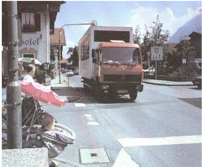
Abb.2 9 : Rechts neben Lkw: Wechselverkehrszeichenanlage
